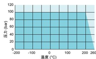
图表中温度和压力建议应用于厚度为2.0mm并且带有光滑法兰面的垫片。压力越高，使用的垫片可能越薄。
